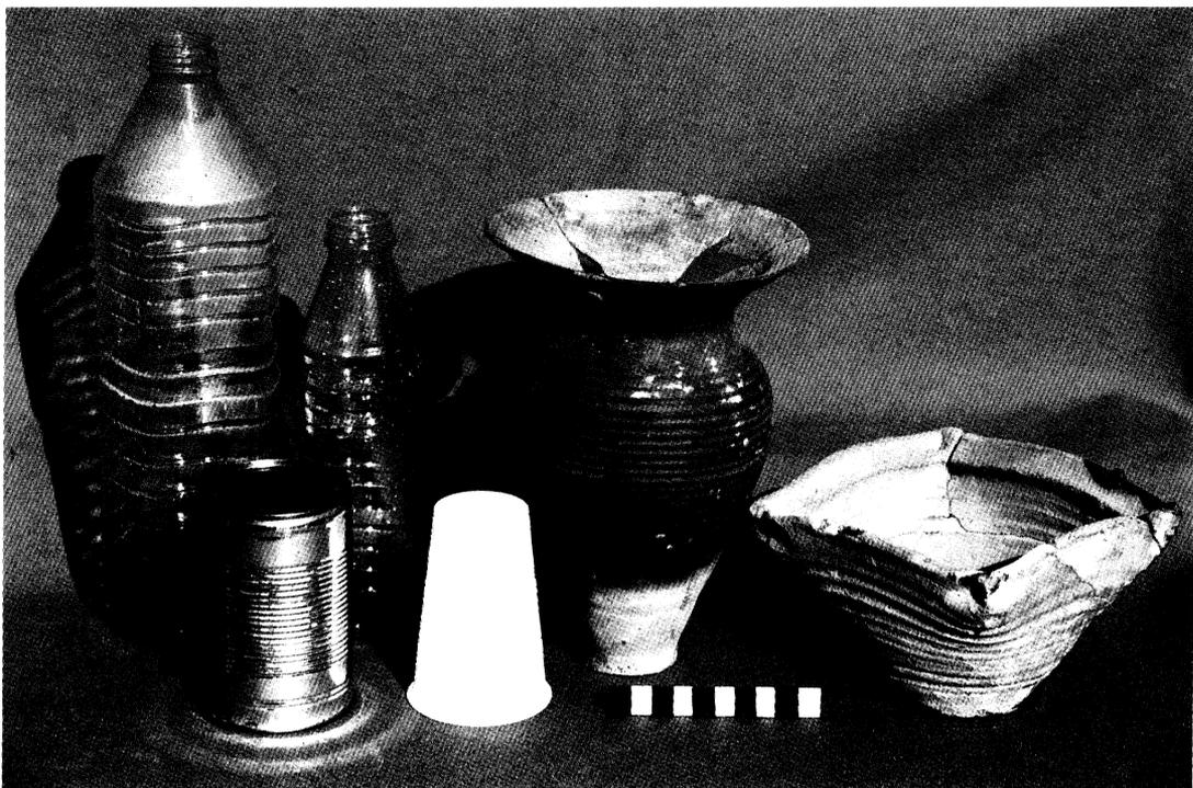
Fig. 7. Exemple d'objets dont la paroi cannelée permet une résistance mécanique latérale.
