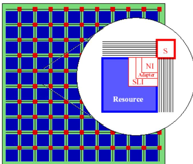
Fig. 2.4: Réseau vu comme un ensemble de commutateurs (S), interfaces (NI), et ressources. Le réseau permet une effective structuration de l'interconnexion.
