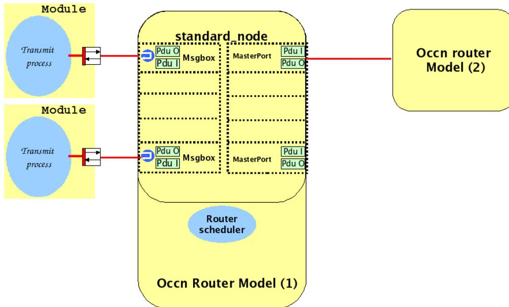
Fig. 2.7: Infrastructure d'un modèle de nœud
