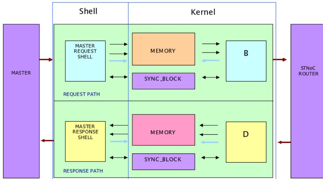
Fig. 2.8: Modèle de microarchitecture d'une interface réseau
