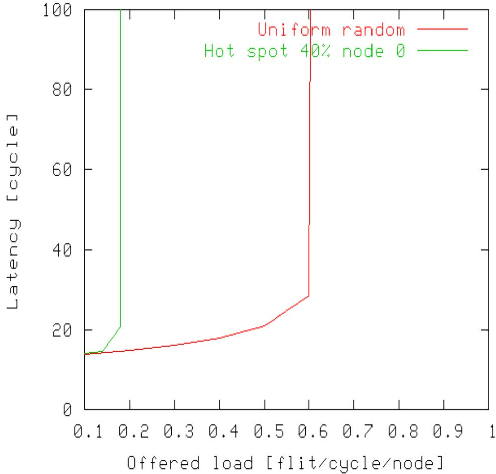
Fig. 2.12: Latence d'un réseau STNoC™ 8x8, avec trafic « hot-spot » et aléatoire
