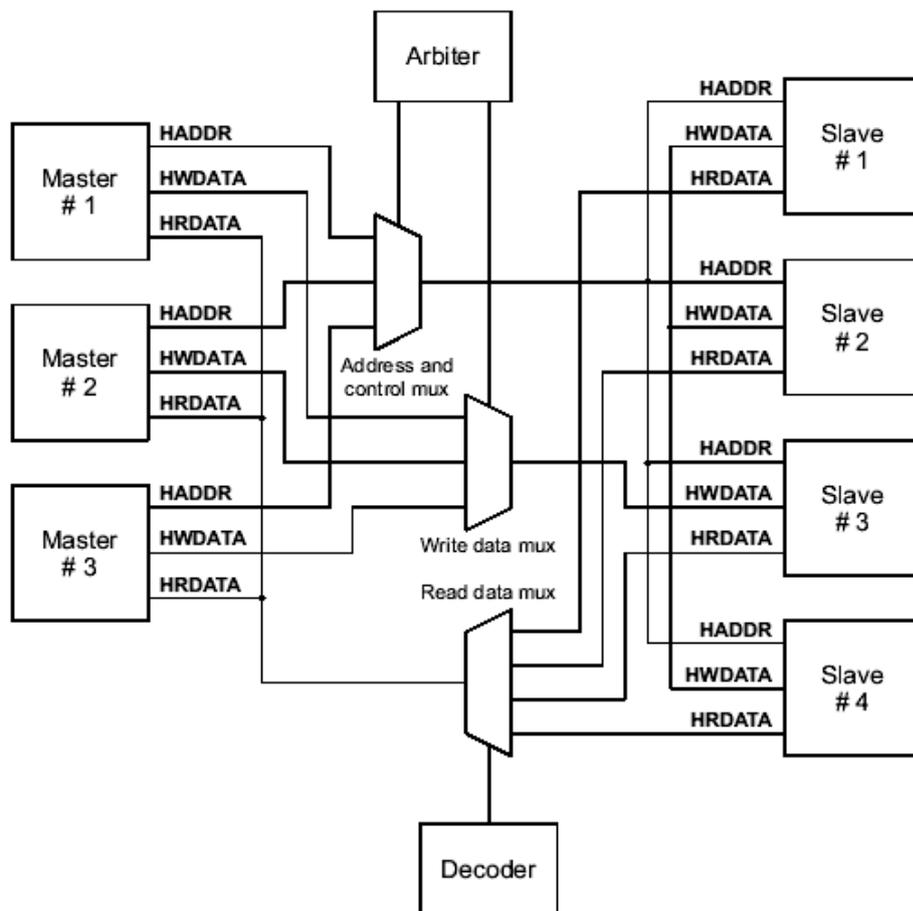
Fig. 2.1: Un exemple d'architecture de bus [2] (ARM AHB).
