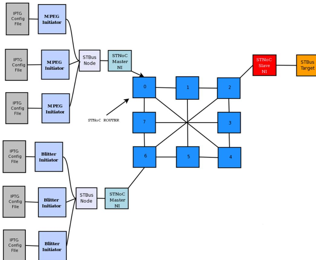
Fig. 2.13: Architecture de l'expérimentation menée sur STNoC™
