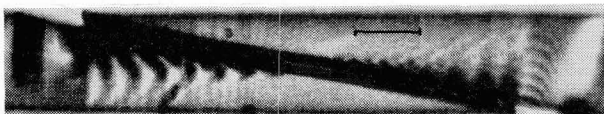
FIG. 14b. — Topographie prise au même endroit que la topographie 14a, après que le cristal ait subi les recuits successifs décrits dans le paragraphe II. Il y a focalisation : la désorientation entre les deux moitiés du cristal parent est pratiquement nulle. L'échelle représente 100 microns.
