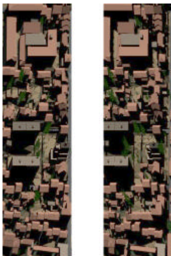
Figure 12. Exemple d'une zone de recouvrement prise sous des angles de \pm 20^\circ .
