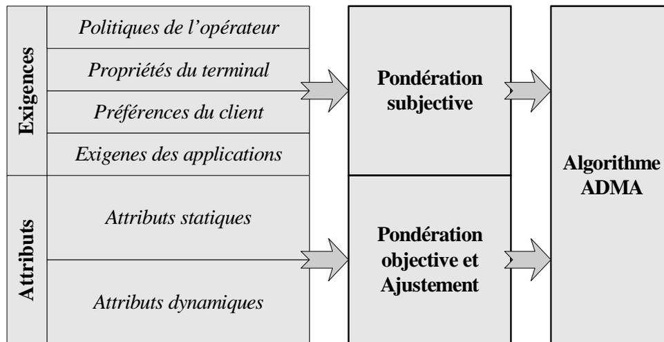
**Figure R- 3 Une solution intégrée pour la sélection du réseau.**
