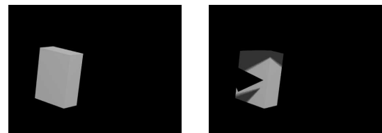
FIG. 6 - objets reconnus, seuls ou avec les objets de synthèse ombrants. L'assombrissement est donné par le ratio des images.
