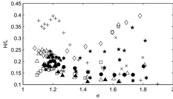
Fig. 8. Aspect ratio  $H/L$  according to the cavitation number  $\sigma$ :  $\times$ : plate 0,  $\star$ : plate 1,  $\triangle$ : plate 2,  $\ast$ : plate 3,  $+$ : plate 4,  $\blackstar$ : plate 5,  $+$ : plate 6,  $\star$ : plate 7,  $\square$ : plate 8.
