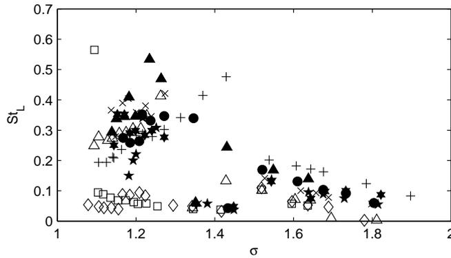
Fig. 13. Strouhal number  $St_L = \frac{Lf_L}{v_{throat}}$  according to the cavitation number  $\sigma$ :  $\times$ : plate 0,  $\star$ : plate 1,  $\triangle$ : plate 2,  $\ast$ : plate 3,  $+$ : plate 4,  $\star$ : plate 5,  $+$ : plate 6,  $\diamond$ : plate 7,  $\square$ : plate 8.
