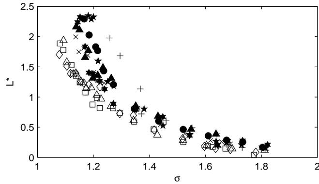
Fig. 6. Undimensional sheet cavity length  $L^* = L/H_{throat}$  according to the cavitation number  $\sigma$ :  $\times$ : plate 0,  $\star$ : plate 1,  $\triangle$ : plate 2,  $\blacktriangle$ : plate 3,  $+$ : plate 4,  $\star$ : plate 5,  $+$ : plate 6,  $\diamond$ : plate 7,  $\square$ : plate 8.
