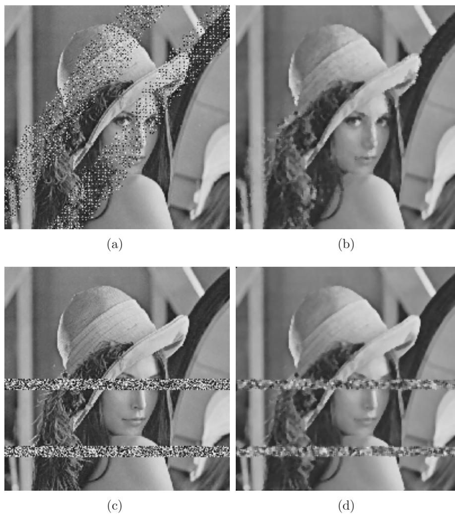
**Figure 4.9** – (a) Reconstruction après la perte 2 paquets, contenant chacun 2000 points. (b) Restauration de (a) avec un filtre médian  $3 \times 3$ . (c) Perte équivalente à (a) (2 fois 2000 pixels consécutifs perdus), mais dans le cas d’une transmission ligne par ligne. (d) Filtrage de (c) avec un filtre médian  $3 \times 3$ .
