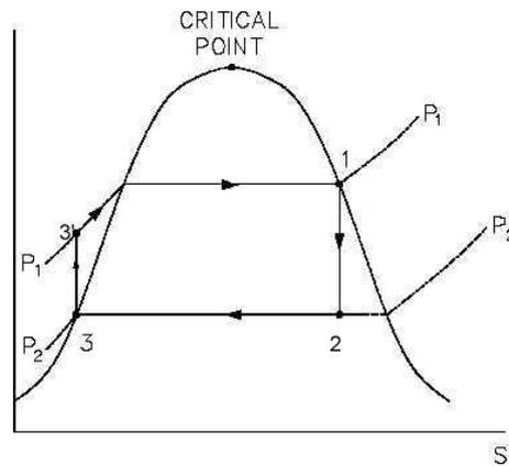
Le point 1 est sur la courbe de saturation. Le cycle s'effectue entre deux isobares HP et BP :
