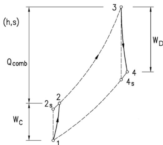
On introduit trois rapports : deux rapports thermiques de compression  $\lambda = \left(\frac{P_2}{P_1}\right)^{\frac{\gamma-1}{\gamma}} = \frac{T_{2is}}{T_1}$
