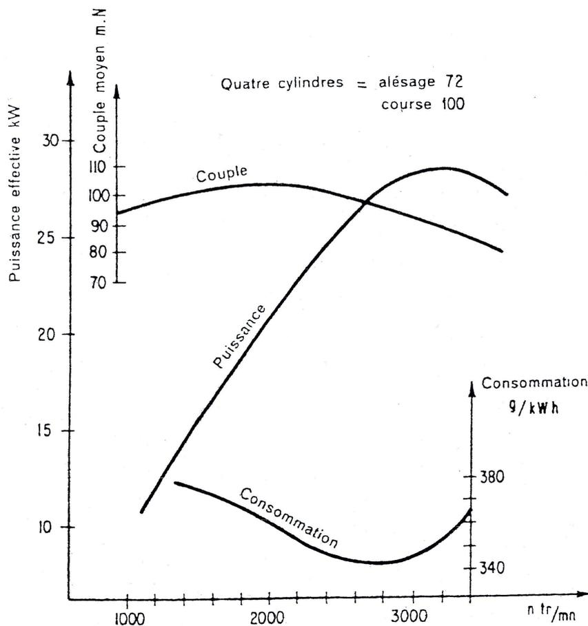
FIG. V.6 – Couple et puissance effective d'un moteur essence
