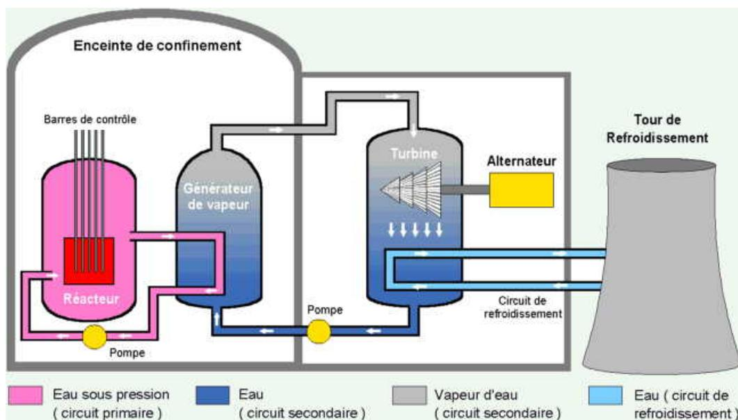
FIG. VI.8 – Schéma d'un réacteur de type REP
