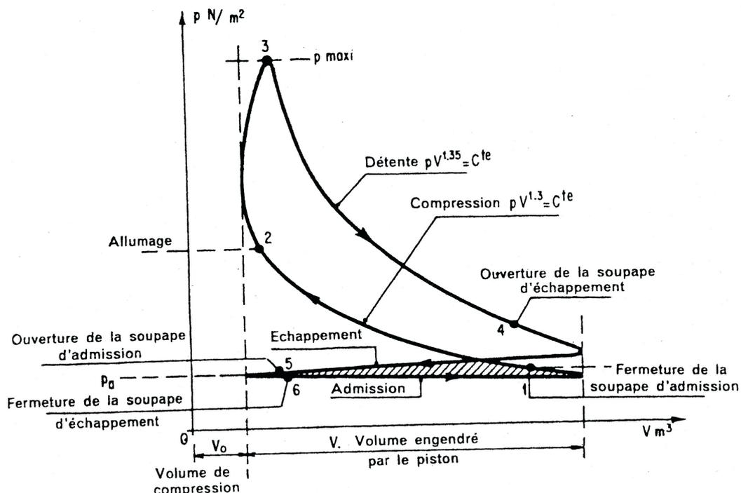
On introduit un **taux de remplissage** pour mesurer l'écart entre la masse théorique admissible dans la cylindre et la masse effectivement admise.
