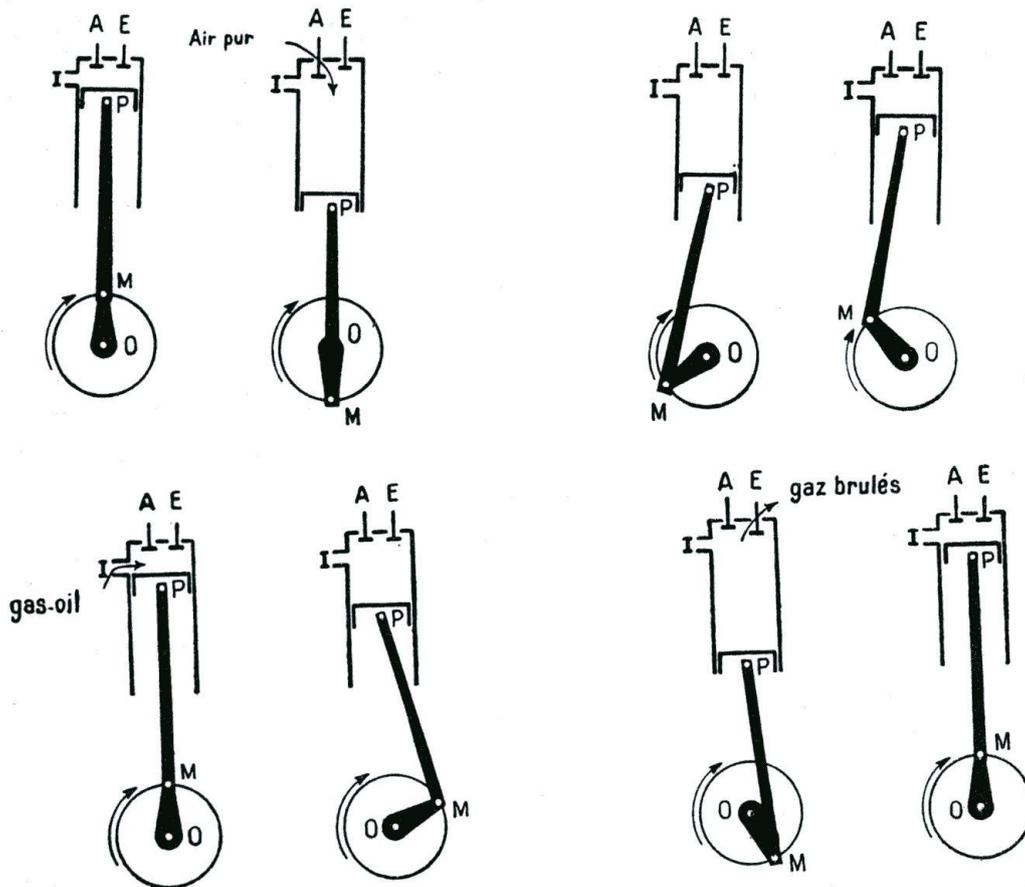
FIG. V.2 – Cycle d'un moteur à allumage par compression
