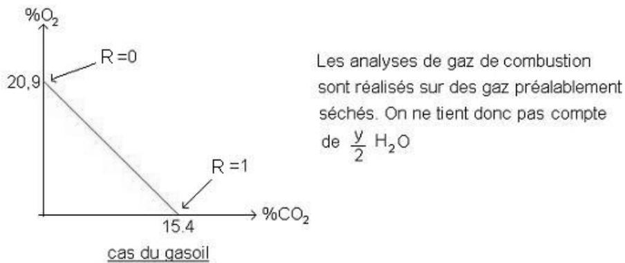
Remarque : En réalité, la droite de Grebel n'est pas tout à fait une droite. On observe une dérive car une partie du carbone n'est pas complètement oxydée → présence de  $CO$  dans les gaz d'échappement.
