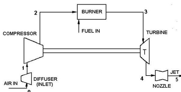
Le cycle thermodynamique qui représente bien les transformations des turbines à gaz est le cycle de Brayton.
