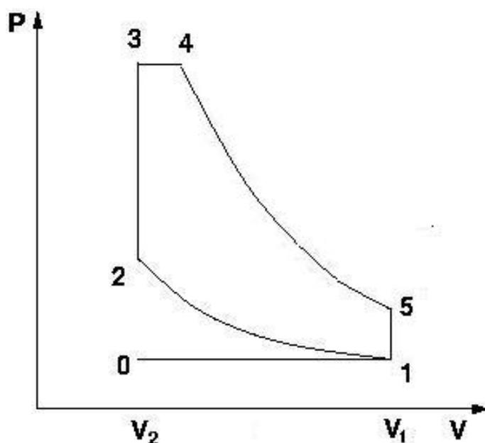
Données : le rapport volumétrique de compression :  $\rho = V_1/V_2$ , le rapport des pressions dans la combustion isochore :  $\lambda = P_3/P_2 = T_3/T_2$  et le rapport des volumes dans la combustion isobare :  $\varepsilon = V_4/V_3 = T_4/T_3$ .
