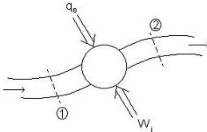
$w_i$  est le travail indiqué, c'est le travail massique échangé entre le fluide et les parties mobiles. Aux pertes mécaniques près,  $W_i$  correspond au travail fourni sur l'arbre.  $q_e$  est la quantité de chaleur massique échangée entre le fluide et l'organe.
