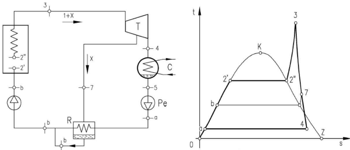
Quantité initiale de fluide  $(1 + x)$ . Soutirage d'une fraction  $x$ . Le cycle de la partie non soutirée :
