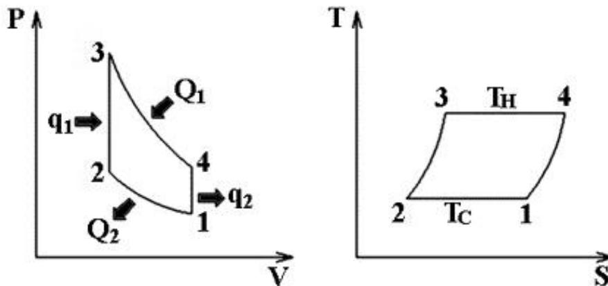
On cherche à accumuler la quantité de chaleur extraite du fluide au cours de 4 - 1 (dans le régénérateur) pour la restituer au fluide au cours de 2 - 3. Le régénérateur est dit parfait si la totalité de la quantité de chaleur  $Q_{23}$  est récupérée sur la détente 4 - 1. Dans ce cas, on a :
