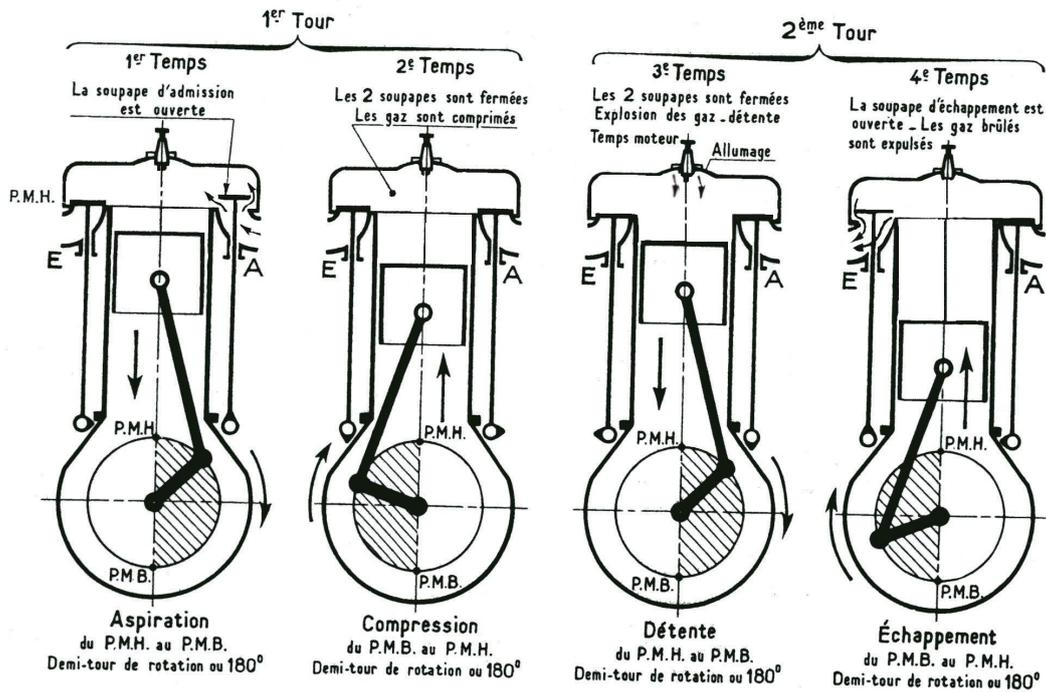
FIG. V.1 – Cycle d'un moteur à allumage commandé
