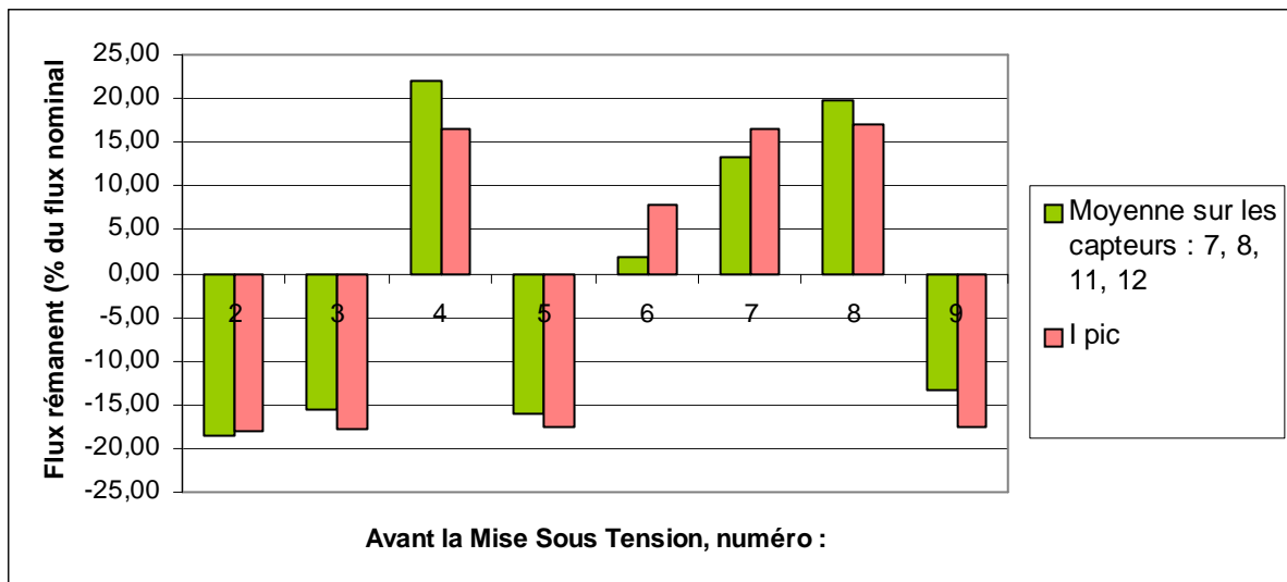
Figure V-36. Moyenne et écart type autour de l'estimation du flux sur les capteurs : 7, 8, 11, 12
