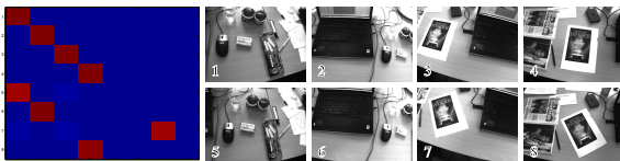
FIGURE 6 – Résultats de l’algorithme FAB-MAP sur l’une de nos séquences. L’entrée (i, j) de la matrice est la probabilité que l’image i provienne du même lieu j . Les faibles valeurs sont en bleues, les fortes valeurs sont en rouges. Les fortes probabilités en dehors de la diagonale principale indiquent la reconnaissance d’un lieu déjà visité. Pour les valeurs de la diagonale, l’entrée (i, j) est la probabilité que l’image i provienne d’un nouveau lieu.
