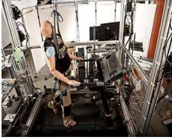
Mannequin sur une plateforme robotique expérimentale de rééducation assistée de la marche à domicile.
