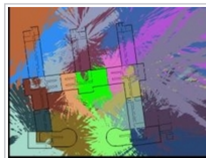
En 2004, simulation de la couverture WiFi en différents endroits d'un immeuble - © Inria - Equipe Ares
