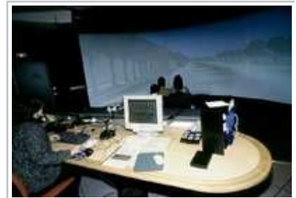
Immersion 3D avec lunettes stéréo actives et calculateur graphique haute performance - © Inria / Photo R. Lamoureux
