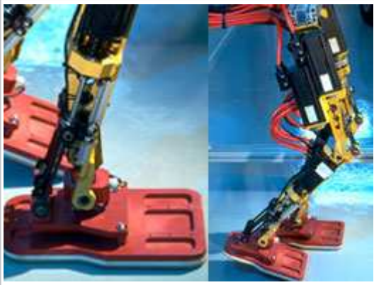
BIP 2000, robot bipède anthropomorphe : les chevilles et les pieds - © Inria / Photo A. Eidelman
