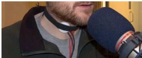
FIGURE 3.3 – Electrodes de l'EGG
