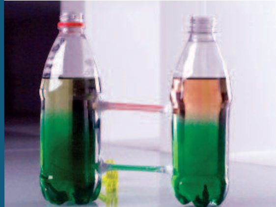
Figure 1 Expérience des deux bouteilles : l'eau rouge, plus légère que l'eau verte, passe au-dessus.
