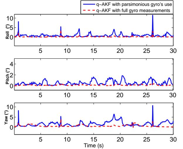
Fig. 4. Euler Angles Estimation Errors
