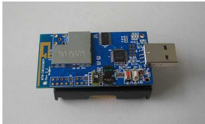
FIGURE 2.1: Photo d'un noeud du réseau
