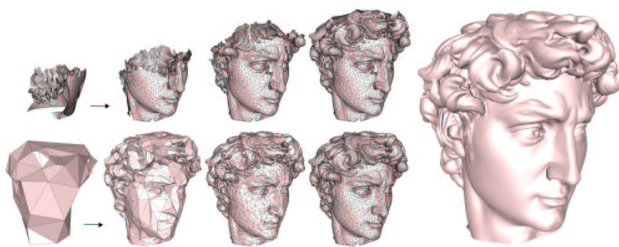
FIG. 2 – Les étapes intermédiaires de reconstruction d'un modèle pendant la décompression d'une technique mono-résolution (en haut) ou progressive (en bas).
