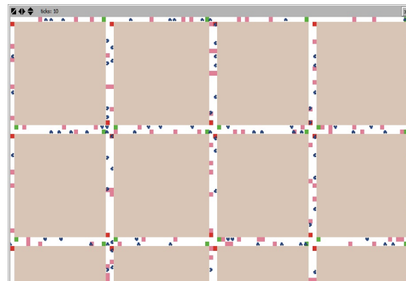
FIGURE 1 – Topologie de l'environnement : les véhicules intelligents (icônes bleues) circulent sur la voie de droite des rues (pixels blancs) jusqu'à une destination (pixels roses), chaque croisement possède un feu de signalisation par voie entrante (pixels verts / rouges).
