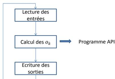
**Figure 1:** Fonctionnement cyclique et séquentiel de l'API
