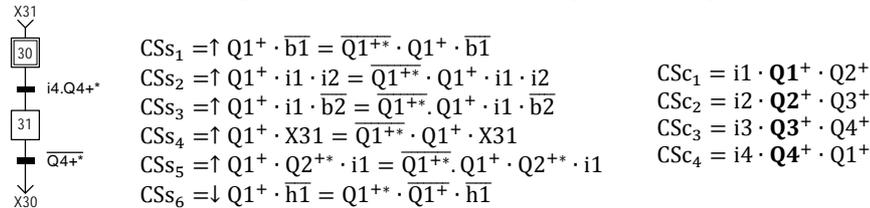
Figure 9 : Sous-ensemble de contraintes de sécurité relatif au vérin 1
