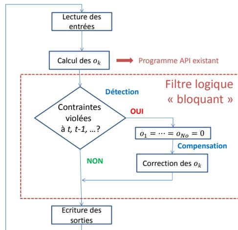
Figure 3 : Principe du filtre logique « bloquant »
