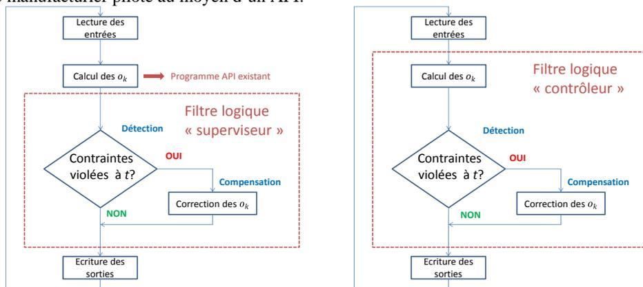
Figure 4 : Principe du filtre logique « superviseur » et « contrôleur »
