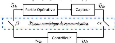
**Figure 1 :** Système interconnecté en réseau pouvant subir une perte de paquets
