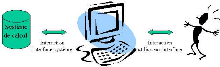
Figure 7. Deux niveaux d'interaction existent en FIGUE. L'utilisateur peut sélectionner des objets du document. La structure de ces objets est utilisée pour communiquer ensuite une requête à un système de calcul.
