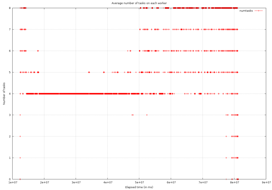
FIGURE II.13 – Equilibrage de charge moyen durant l’exécution de Cholesky tuilé
