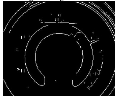
Fig.17. Sobel edge detection result
