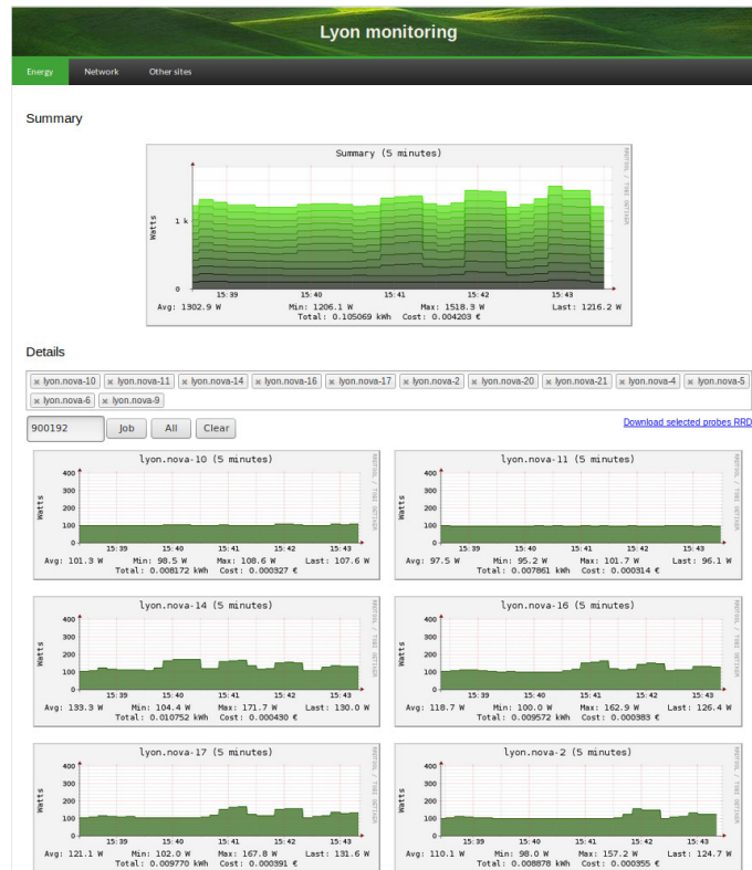
Figure 3 - Interface du logiciel Kwapi , qui permet de visualiser en temps réel la consommation énergétique des nœuds lors d'une expérience
