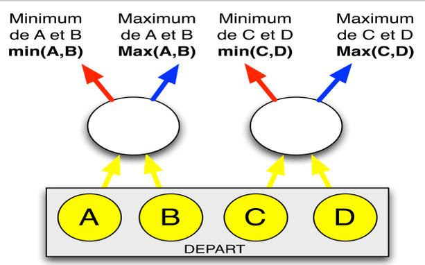
L'expérience montre que l'on est tenté de comparer la flèche bleue de gauche (Max(A,B)) et celle rouge de droite (Min(C,D)). Pourtant, on peut faire **mieux** (construire un réseau de tri **avec moins de trieurs**)
