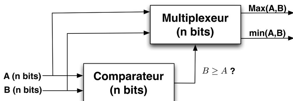
Le circuit de gauche est une façon « d'implémenter » les trieurs (les « ronds blancs » des réseaux de tri)
