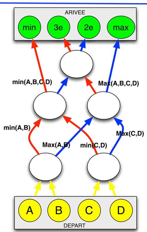
**Comparer 4 éléments nécessite au plus 5 trieurs.**
