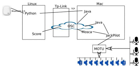
Figure 1. Connexions logicielles et matérielles
