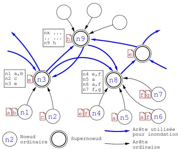
FIG. 4 – Réseau hybride : nœuds et supernœuds
