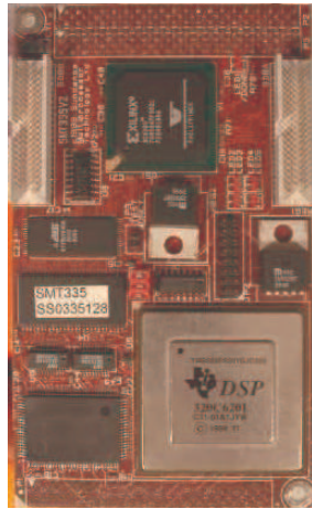
FIG. 8 – Module SMT335 comprenant un DSP C6201, 2 SDB et 6 CP.
