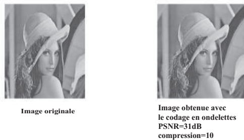
FIG. 10 – Résultats obtenus avec le codage de compression en ondelettes
