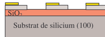
3- Gravure RIE de la piste de polysilicium et dépôt métallique Ti(100A°)/Al(1500A°)/Ni(400A°)/Au(1000A°)
