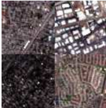
FIG. 5 – Affichage en fausse couleur des canaux \{30,20,10\} d'un collage de textures extraites d'une scène AVIRIS prise au-dessus de Moffett Field en Californie.
