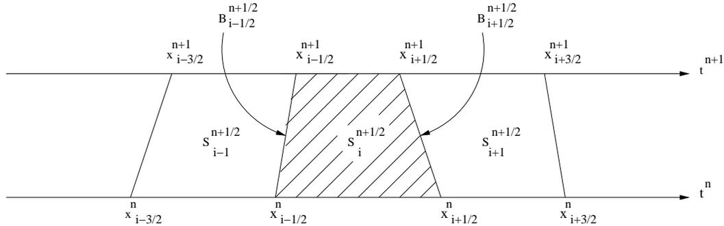
FIG. 1 – Principe des formulations en volumes finis.
