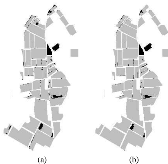
FIG. 15 – Images des erreurs en topologie classique (a) et à trous (b)
