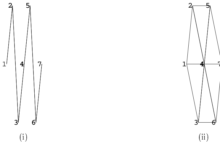
FIG. 23 – Contrainte non fortement Delaunay-admissible. (i) : contrainte initiale, (ii) : triangulation de Delaunay.
