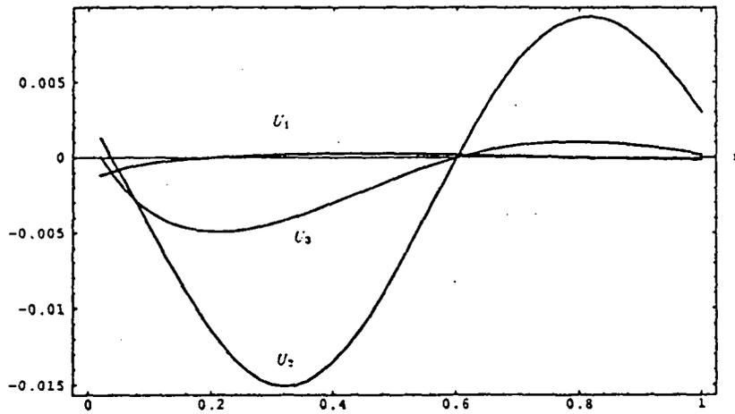
Mode 2 de vitesse  $\bar{c} = 0.750$ .
