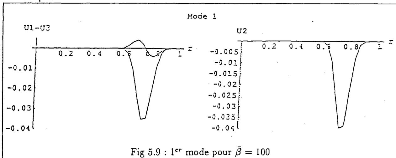
On observe que l'énergie de l'onde est concentrée autour de la position  $r = 0.75$  qui correspond au minimum de la fonction  $\frac{\mu(r)}{\rho(r)}$  sur  $[0,1]$ . De plus, le maximum de l'amplitude  $u_3$  a tendance à devenir nul. Ce comportement illustre bien les propriétés démontrées dans le théorème 3.16 de [5].
