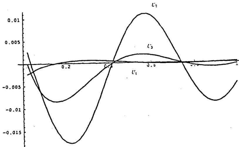
Mode 3 de vitesse  $\bar{c} = 0.845$ .Fig 5.11 : Amplitudes des modes de flexion qui apparaissent à  $\bar{\beta} = 12$ .
