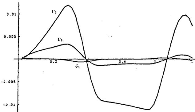
Mode 3 avec  $\bar{\beta} = 15$  et  $\bar{c} = 0.940$
