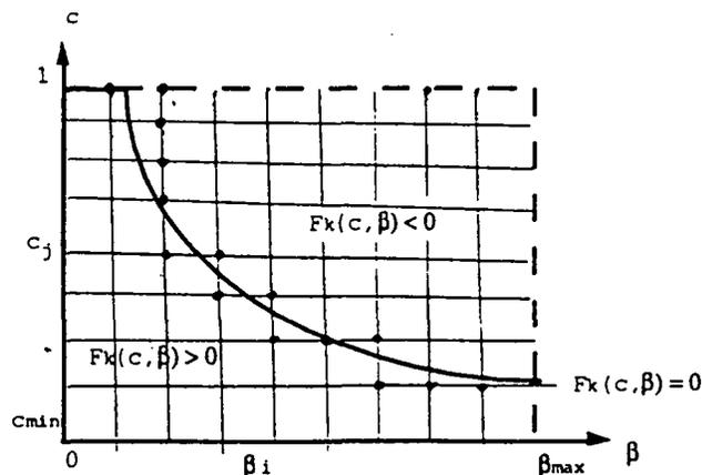
Figure 3.1 : Algorithme pour tracer une courbe de dispersion
