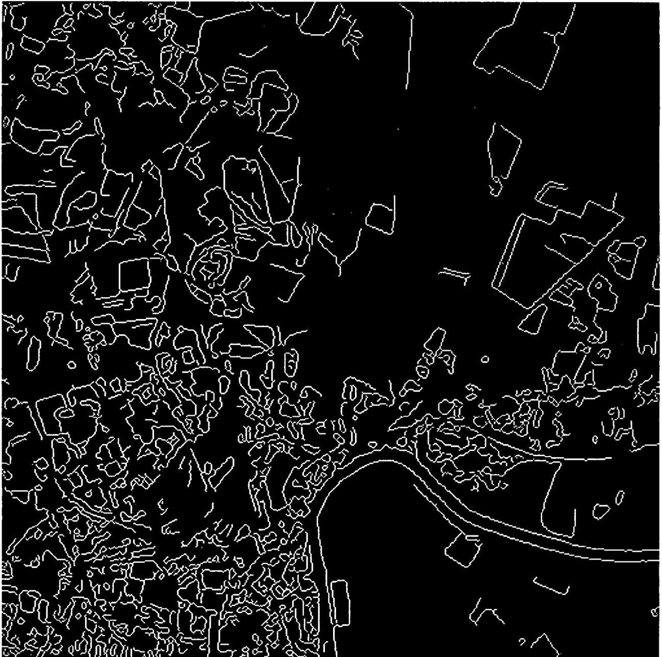
Figure 10: Image satellite SPOT 512x512. Contours par filtre de Canny
