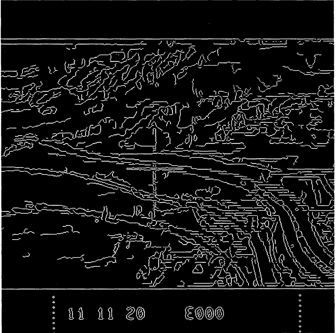
Figure 22: Image aérienne tramée 512x512. Contours par filtre de Canny
