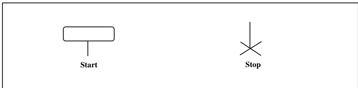
figure 22. Initialisation et terminaison de processus
