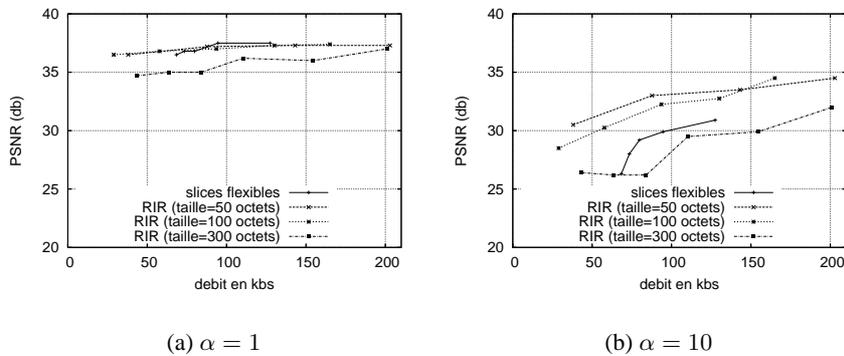
**Figure 8.** Comparaison entre *slices flexibles* et *RIR*
