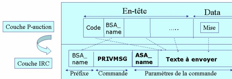
Figure 3. L'encapsulation d'un message transportant une mise
