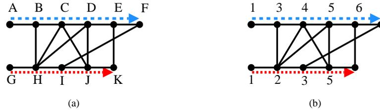
**FIG. 1:** (a) Une instance  $(G, R, P)$  de DAWN-paths contenant 2 requêtes  $r_1 = (A, F)$ ,  $r_2 = (G, K)$ ,  $P(r_1) = (A, B, C, D, E, F)$  and  $P(r_2) = (G, H, I, J, K)$ . (b) Une assignation de dates valide, sans conflit, et optimale (b).
