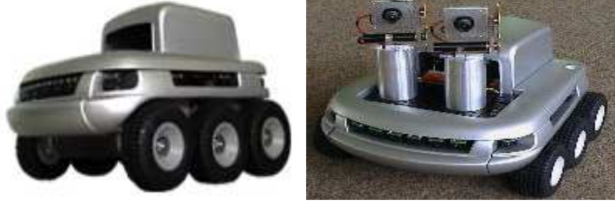
FIG. 4.6: Le Koala et ses deux caméras mobiles (le robot utilisé dans les expériences ne possède qu'une seule caméra).
