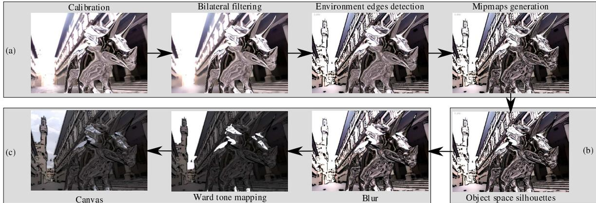
**FIG. 7:** Pipeline utilisé pour créer le style cartoon : (a) - précalculs, (b) - shading dans l'espace objet, (c) - post-traitements. Nous montrons l'influence de chacune des étapes pour le rendu de ce style.
