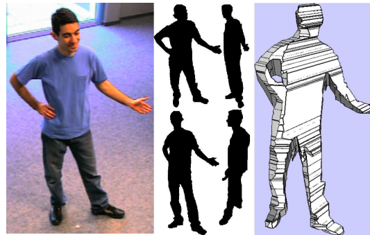
FIG. 6 – Reconstruction temps-réelle d'une personne avec 4 caméras et l'approche surfacique exacte.
