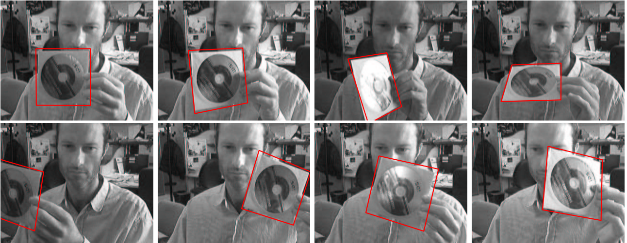
FIG. 8 – Suivi d’un objet dans l’image par estimation robuste d’une transformation homographique. L’objet suivi est entouré en rouge.
