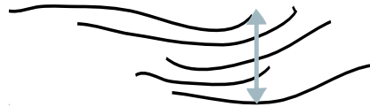
FIG. 7 – L’erreur associée à un groupe de lignes (son épaisseur) correspond à la distance maximale entre deux lignes (les « plus éloignées »).
