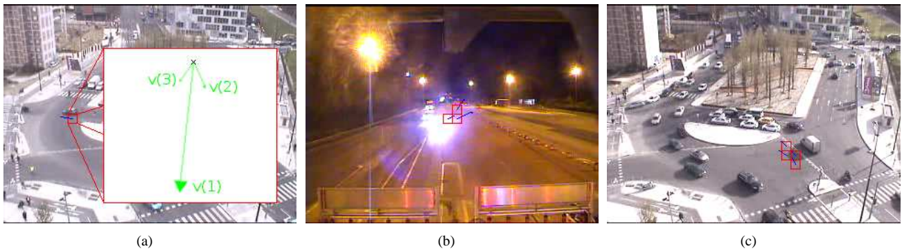
FIG. 6 – Exemples de fausses alarmes. (a) Oubli lors de l'apprentissage. Les trois vecteurs du modèle éparés ont été représentés en vert. Les trois vont vers la bas. (b) Problème d'ouverture. Le flot optique est orthogonal à la bordure du faisceau de lumière, donnant des résultats complètement faux. (c) Problème de projection. L'ombre s'étend sur des zones où aucun mouvement vers le haut gauche de l'image n'a été appris.
