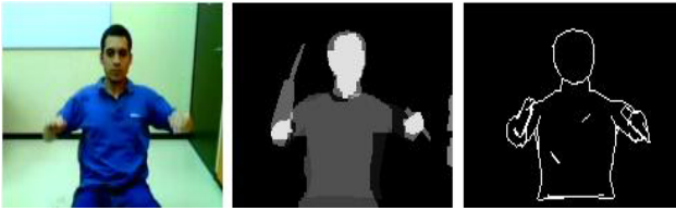
Figure 5 : Correction du recalage sur les régions. Les images sont respectivement l'image acquise ; le modèle superposé sur l'image segmentée, avec un recalage incorrect du bras droit ; les contours occultants du modèle 3D dans la position finale avec recalage sur les contours.
