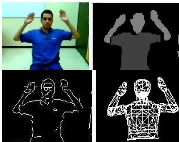
Figure 1: Notre approche pour l'acquisition 3D des gestes. Les images sont respectivement : l'image acquise, l'image segmentée en classes de couleur, les contours dans le masque d'avant-plan et finalement la projection du modèle 3D du corps humain recalé.
