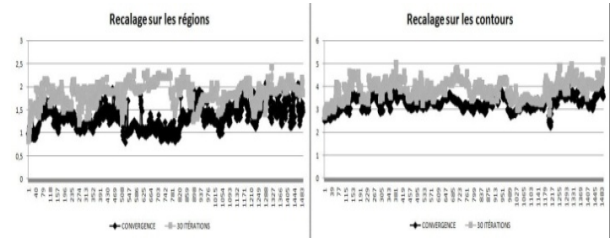
Figure 7 : Effet d'un nombre limité d'itérations sur l'erreur résiduelle (les ordonnées). En abscisse : le numéro de l'image dans la séquence vidéo. En ordonnée : le taux de non recouvrement minimisé par le recalage sur les régions (à gauche) et la distance moyenne résiduelle entre contours minimisée par le recalage sur les contours (à droite). La ligne noire correspond à la convergence tandis que la ligne grise correspond à 30 itérations.
